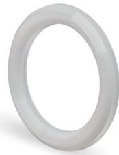
Les bagues de support renforcent les joints toriques d'étanchéité radiale pour éviter une extrusion de fission, des fuites ou des endommagements du joint. Cela permet l'utilisation de joints toriques dans différents champs d'application. Freudenberg Xpress® propose des bagues de support dans différents matériaux, notamment le PTFE, POM, PA, PEEK et polyuréthane. Ils sont ainsi adaptés à de nombreuses industries.
