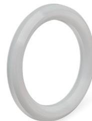
Le polyéthylène (PE) est un thermoplastique semi-cristallin avec une bonne résistance à l'usure et à la friction et de bonnes propriétés isolantes. Il résiste à différents fluides, p. ex. des acides, lessives diluées, huiles et graisses. De plus, le PE offre une faible absorption de l'eau, ce qui permet une utilisation dans l'industrie de transformation. La plage de températures d'utilisation s'étend d'env.  $-200^{\circ}\text{C}$  à  $+80^{\circ}\text{C}$ .
